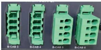
Abbildung 14. Stecker für Hilfsversorgung am B-Cab
