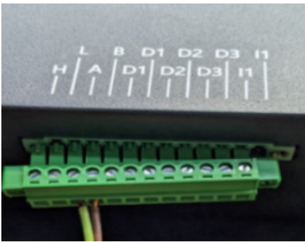
Abbildung 4: Beispiel eines Steckers für das GBMS einer Vision-Batterie
