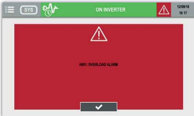
Berühren Sie die entsprechende Taste, um den Summer abzuschalten und die Popup-Meldung zu schließen. Nach dieser Maßnahme wird automatisch die Alarmseite angezeigt.
