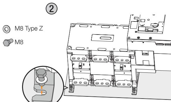
**Achtung:** das Gerät muss stets auf einem ebenen und festen Untergrund installiert werden.
