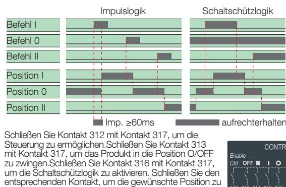
Schließen Sie Kontakt 312 mit Kontakt 317, um die Steuerung zu ermöglichen. Schließen Sie Kontakt 313 mit Kontakt 317, um das Produkt in die Position O/OFF zu zwingen. Schließen Sie Kontakt 316 mit Kontakt 317, um die Schaltenschützlogik zu aktivieren. Schließen Sie den entsprechenden Kontakt, um die gewünschte Position zu erreichen.
