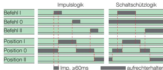
Schließen Sie Kontakt 312 mit Kontakt 317, um die Steuerung zu ermöglichen. Schließen Sie Kontakt 313 mit Kontakt 317, um das Produkt in die Position O/OFF zu zwingen. Schließen Sie Kontakt 316 mit Kontakt 317, um die Schaltschützlogik zu aktivieren. Schließen Sie den entsprechenden Kontakt, um die gewünschte Position zu erreichen.
