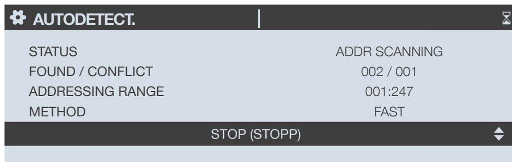
Wenn eine automatische Adressenkonfliktbehebung („AUTO SET (AUTOM. EINST.)“) gewählt ist, wechselt der STATUS (STATUS) automatisch zu „STOPPED (GESTOPPT)“, sobald der automatische Erkennungsprozess abgeschlossen ist.
