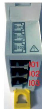
Der an den Stromeingang 1 angeschlossene Stromsensor misst den Strom von Phase 3 (V3).
