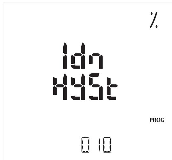
Den Wert mit den Tasten “▶” und dann “▼” oder “▲” eingeben. Der Wert wird prozentual vom IΔn ausgedrückt.
