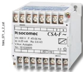
Messumformer wandeln elektrische AC-Werte (A, V, Hz, Cos phi, W, Var) in einheitliche DC-Signale für Strom oder Spannung um. Sie sind auch mit Aufbaugeschäften verfügbar (Reihe CS). Die Geräte sind für die Montage auf Hutschienen oder der Rückwand vorgesehen.
