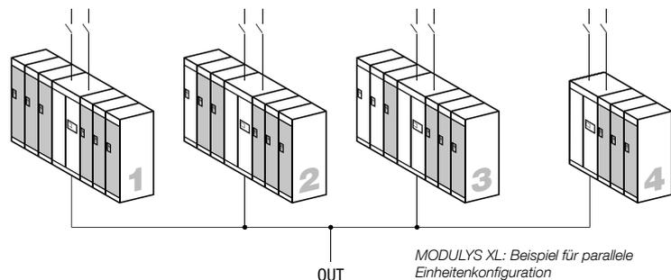
MODULYS XL: Beispiel für parallele Einheitenkonfiguration
