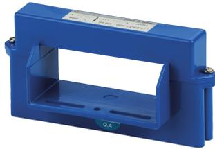
DC-Stromsensoren messen DC-Lastströme in elektrischen Installationen und übertragen die Werte zu den Idc-Messmodulen modulseitig über einen RJ12-Anschluss und sensorseitig über einen Molex-Anschluss. Die Reihe umfasst teilbare Sensoren von 50 bis 2000 A in verschiedenen Größen für neue oder bestehende Installationen. An ein DIRIS Digiware Idc-Modul können bis zu 3 verschiedene DC-Sensoren angeschlossen werden.
