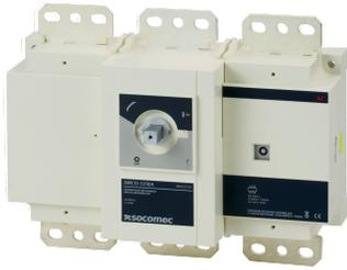
SIRCO AC-Einheiten sind manuelle oder motorisierte mehrpolige Lasttrennschalter. Sie schließen und öffnen unter Last und gewährleisten eine Sicherheitstrennung. SIRCO AC-Geräte sind ausgelegt für extreme Anwendungen bis 690 VAC - AC-23.
